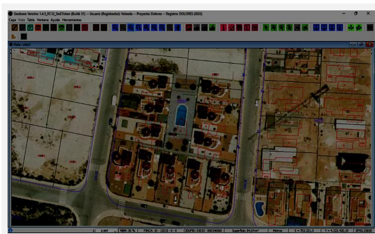
Fig. 2ª: Se observa como la georreferenciación y las relaciones topológicas están desajustadas, pero ambas coinciden por su parte con la realidad física, afectando a un polígono concreto y a una pluralidad de fincas.
